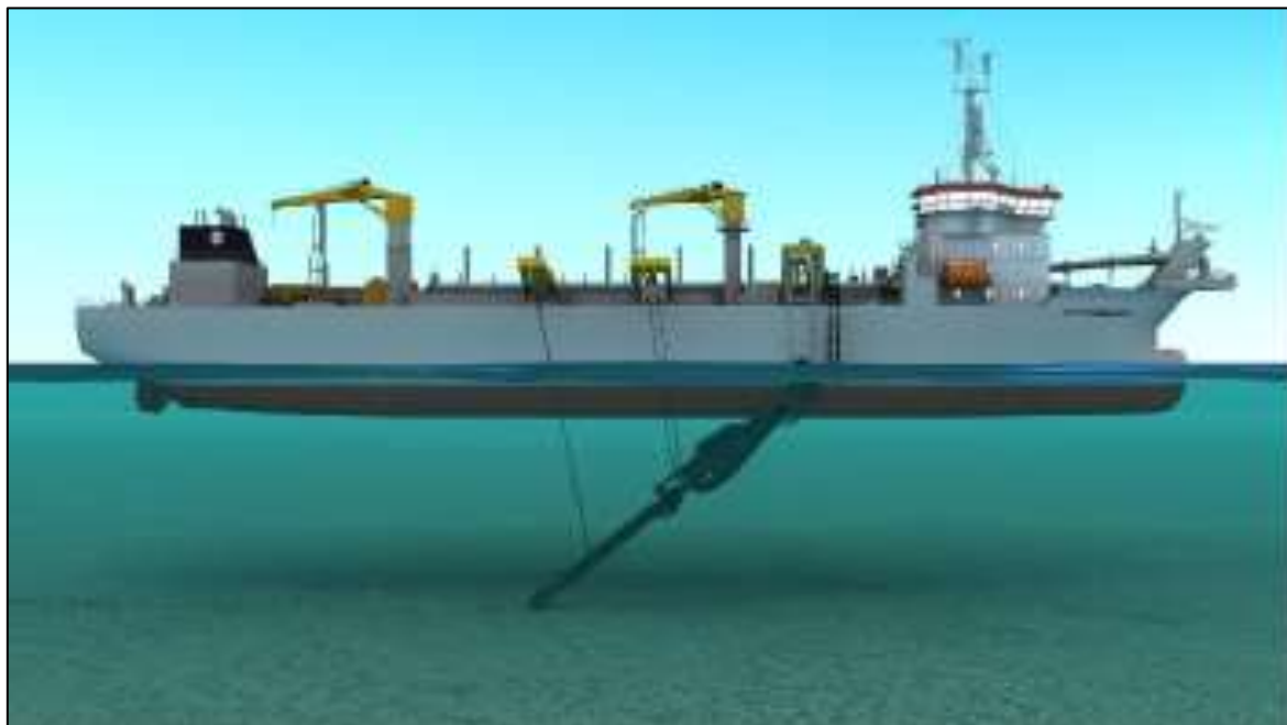
Figura 16 – Ilustração da operação de uma draga hopper
