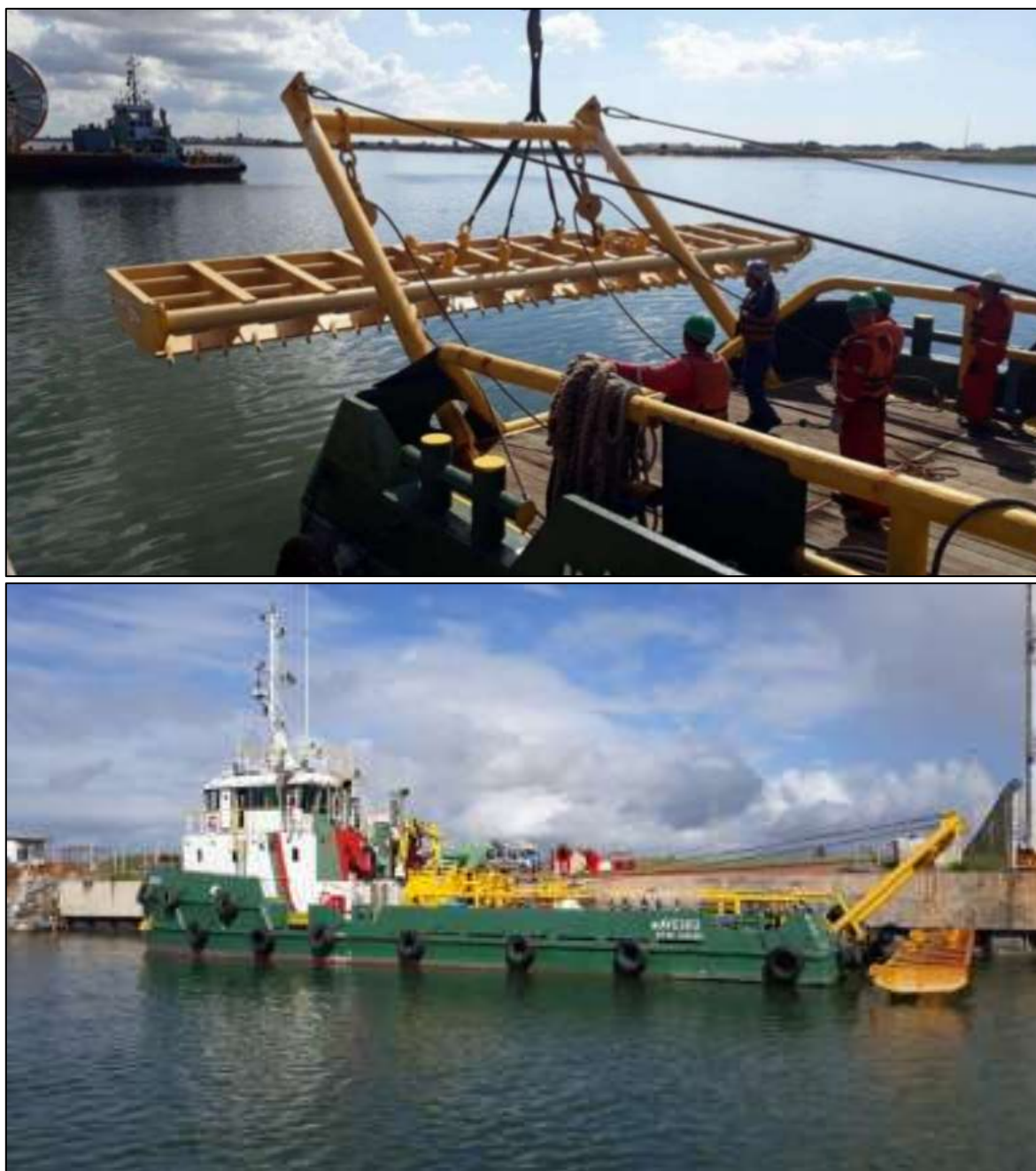
Figura 23 - Lâmina niveladora e embarcação utilizada pela APPA para finalização das áreas da dragagem de manutenção
