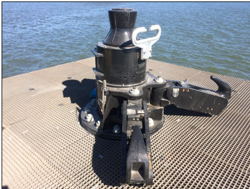
Figura 4: Cabeço de Gancho de Gatilho Rápido (Quick Release Hooks).
