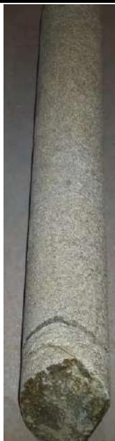
AMOSTRAGEM SONDAGEM MISTA
