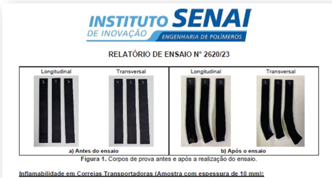
Figura 6 - Relatório de ensaio de correias transportadoras para teste de inflamabilidade – página 114
