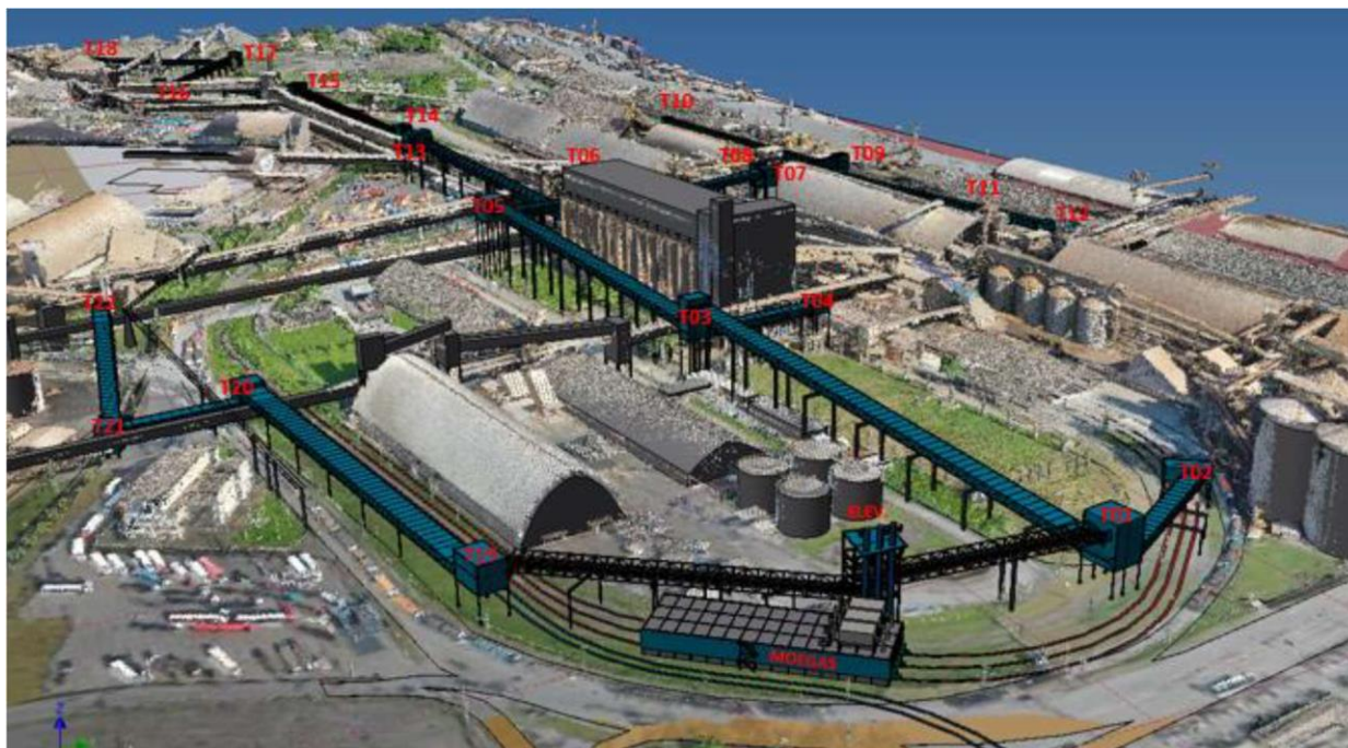
Figura 4 - Imagem em 3D da operacionalização da nova moega ferroviária do Porto de Paranaguá com o transporte do produto descarregado por correias transportadoras diretamente nos terminais.
