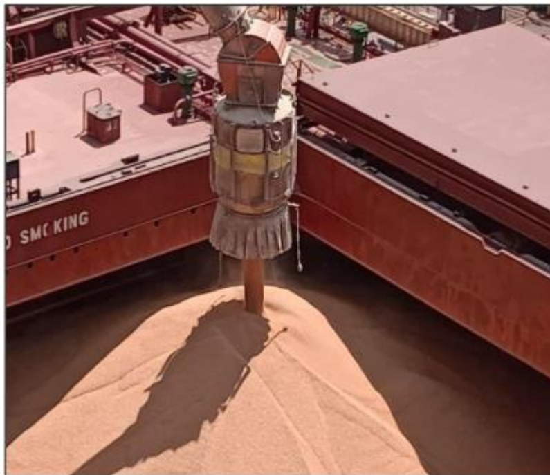
Exemplo de carregador de navios com supressor de pó DSH.
