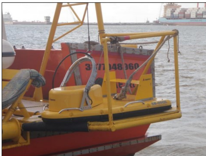
Figura 31. Perfilador de sub-superfície CHIRP Edgetech 512i.
