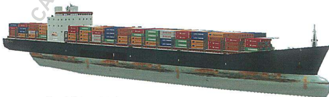
Figura 4: Visão geral do "Container Vessel 02": LOA = 294 metros e boca = 32,2 metros.
