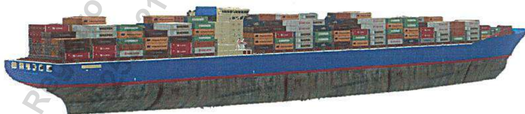
Figura 3: Visão geral do "Container Vessel 01": LOA = 347 metros e boca = 42,8 metros.
