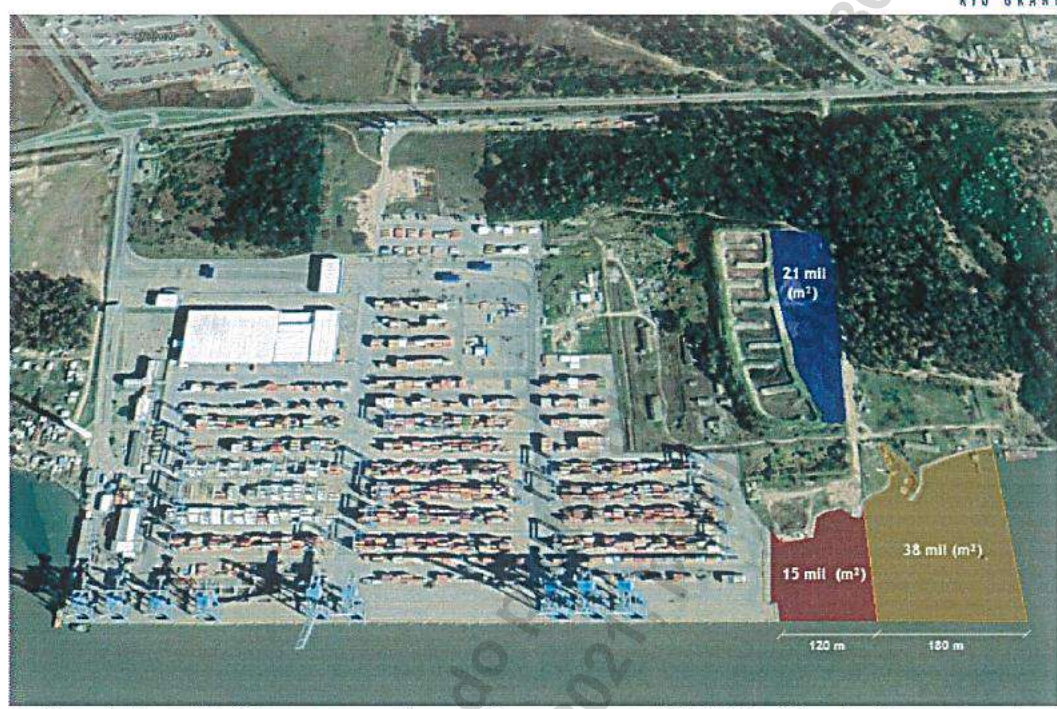
Figura 4: Aterro hidráulico para expansão portuária com emprego 640.000,00 m³ do material a ser dragado.
